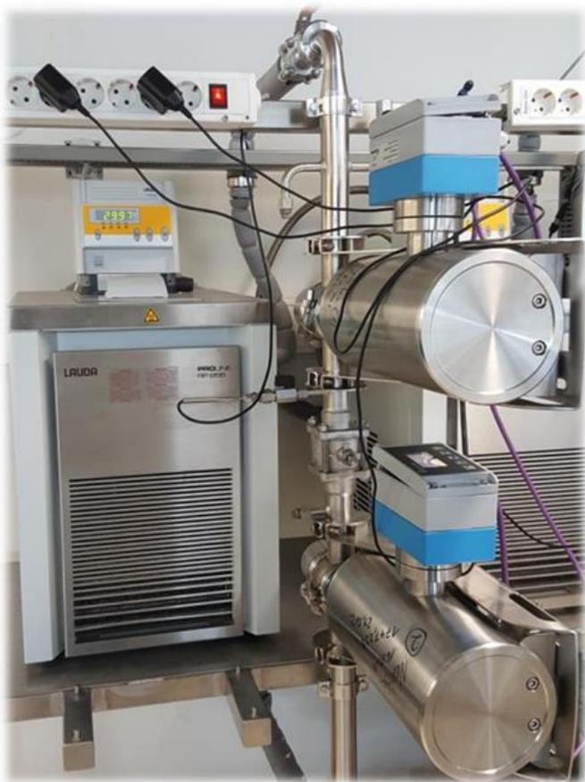
Le densitomètre est étalonné en usine
